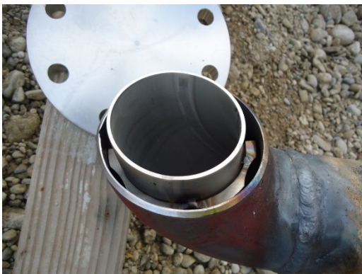
Compactación del relleno (izq.), tubería doble de seguridad de acero soldado (der.)
